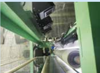
1250レベラーライン自動キズ検査機。 お客様の要望に応じたキズ検出を実施します
