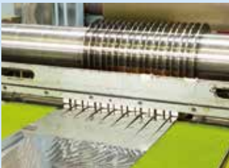
拡張アーバーによる刃ブレ制御カッター
