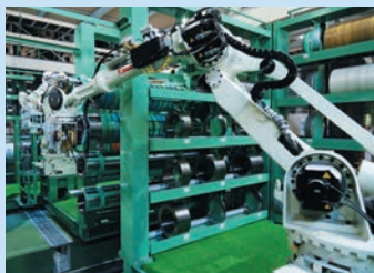
スリッターライン自動刃組ロボット
