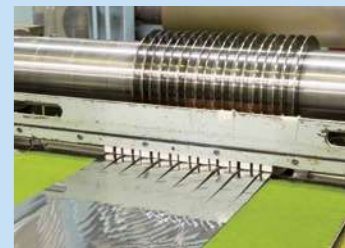
拡張アーバーによる刃ブレ制御カッター
