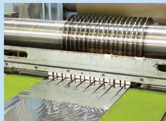
拡縮アーバーによる刃ブレ制御カッター
