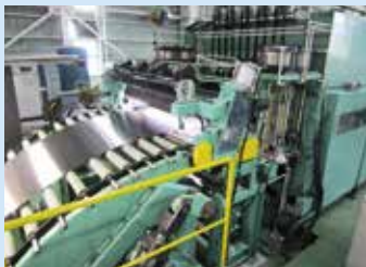
1600レベラーラインに自動キズ検査機を設置し、さらなるCS（顧客満足度）向上を図る
